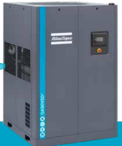
新版《容积式空气压缩机能效限定值及能效等级》标准即国标GB19153-2019从2020年7月1日起生效，新国标规定了变频空压机的能效限定值、等级划分和能效值的计算要求。其是以变频空压机满载气量的40%、70%和100%在标况下的比功率加权平均值划定能效等级的（最小气量大于满载气量40%的变频机以
